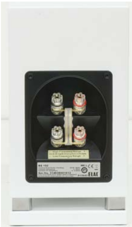
Il pannello posteriore è quasi del tutto occupato dalla generosa vaschetta portacontatti con quattro morsetti dorati ponticellati a due a due con delle pratiche barrette ricoperte di un materiale isolante.
