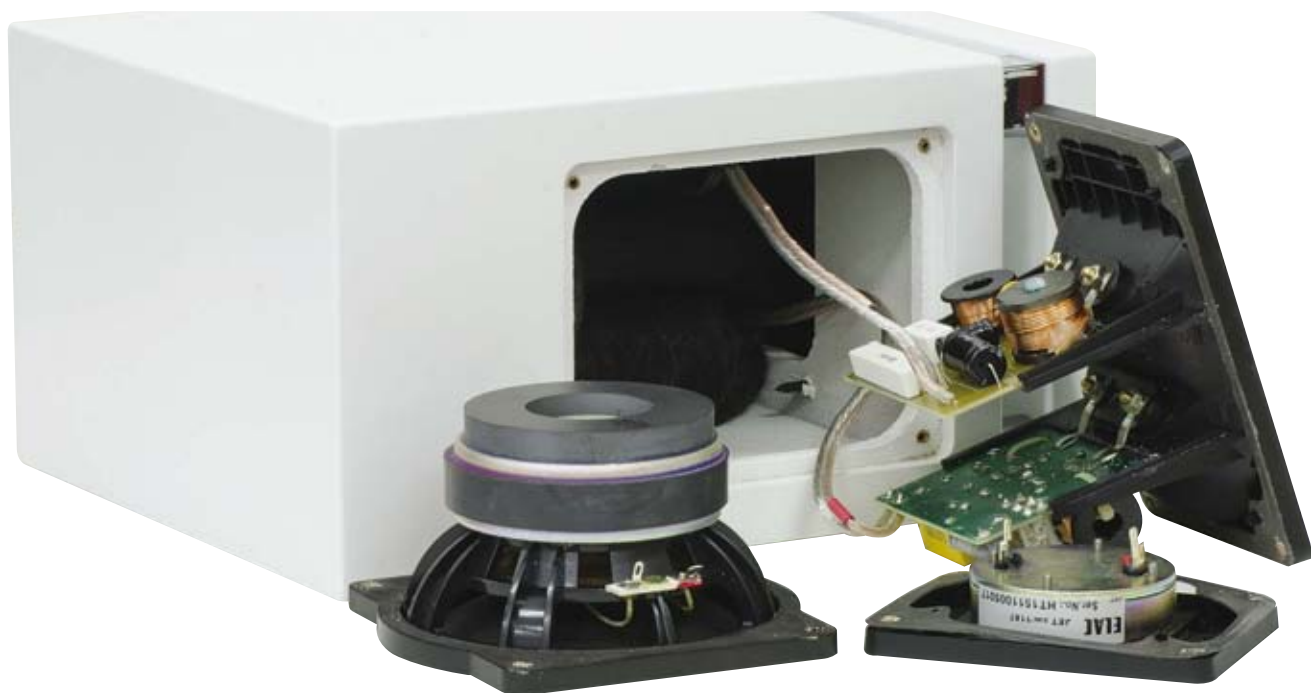
Il diffusore smontato. Notiamo il midwoofer con il doppio anello di ferrite ed il cestello aerodinamico, il coperchio di chiusura del complesso magnetico del tweeter ed i due supporti del crossover sistemati ad incastro nella vaschetta portacontatti. Notare all'interno del diffusore l'assorbente acrilico molto denso e di colore scuro, nonché i cavi di collegamento di buona sezione.
